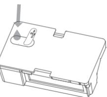
2. Постепенно сдвигните собранный держатель губки в нижнюю часть робота-пылесоса в указанном направлении.
