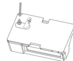
2. Schieben Sie den zusammengesetzten Wischerhalter in der gezeigten Richtung waagerecht in den Boden des Staubsauger-Wischers.
