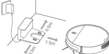
Примечание. Зарядная док-станция должна находиться в хорошо освещенном месте без воздействия прямых солнечных лучей. Уберите расположенные поблизости отражающие предметы (например, зеркала), чтобы они не повлияли на возвращение робота-пылесоса на зарядную док-станцию. Не ставьте зарядную док-станцию на стол во избежание падения.
