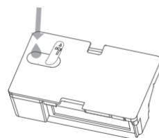
2. Insérez le support assemblé à la serpillière au fond de du robot aspirateur laveur, à l'horizontale, dans le sens indiqué.
