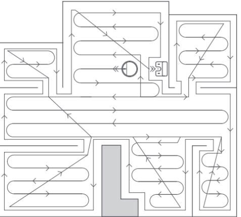
\* Während einer Reinigungsaufgabe wird der Staubsauger-Wischer durch die zu reinigenden Räume fahren und durch Berührung die Grenzen des Raums und die Position der Möbelstücke ermitteln. Das ist normal und hat keine Auswirkungen auf die Reinigungseffizienz.
