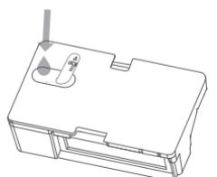
2. Far scorrere lentamente il supporto per panno lavapavimenti assemblato nella parte inferiore dell'aspirapolvere/lavapavimenti nel verso indicato.
