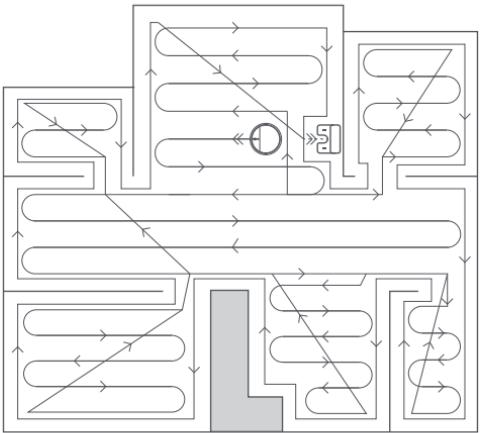
\* Durante una pulizia, l'aspirapolvere/lavapavimenti entra ed esce dalle stanze, comprovando il loro perimetro e il limite rappresentato dai mobili attraverso il contatto con gli stessi. Si tratta di una normale procedura che non influisce sull'efficacia della pulizia.
