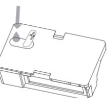
2. Deslice el soporte instalado para la almohadilla de la mopa en la parte inferior del aspirador con mopa de forma nivelada y en la dirección que se muestra.
