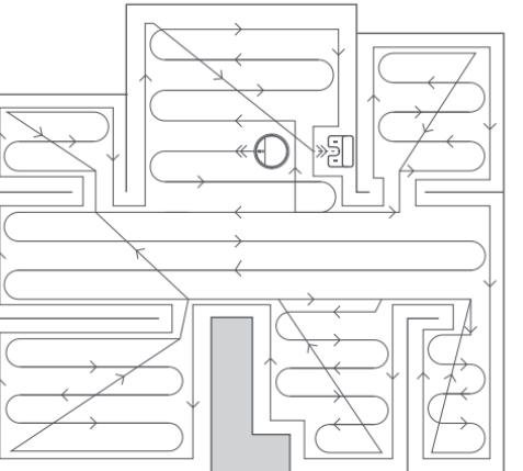
\* Lors d'une tâche de nettoyage, le robot aspirateur laveur entre et sort des pièces et vérifie les contours de la pièce et des meubles en les touchant. Ceci est normal et n'affecte en rien l'efficacité du nettoyage.
