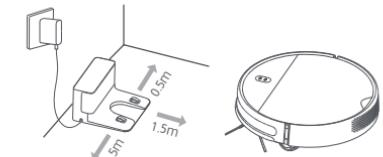
Hinweis: Stellen Sie sicher, dass sich die Ladestation in einer gut beleuchteten Umgebung ohne direkte Sonneneinstrahlung befindet. Entfernen Sie reflektierende Objekte wie Spiegel aus der Nähe der Ladestation. Diese können die Rückkehr des Staubsauger-Wischers zur Ladestation erschweren. Legen Sie die Ladestation nicht auf den Tisch, sie könnte herunterfallen.
