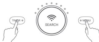
Если устройству не удастся подключиться к телефону, одновременно нажмите кнопки «Функции» и «Таймер» и удерживайте их в течение 5 секунд, чтобы выполнить сброс. Индикатор замигает желтым. Это означает, что настройки Wi-Fi успешно сброшены и вы можете повторно подключиться к сети.
