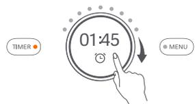
2. Gire el botón de control hacia la derecha para ajustar el tiempo restante y pulse para confirmar. Gire el botón lentamente para ajustar el tiempo en incrementos de un minuto. Gírelo rápidamente para ajustar el tiempo en incrementos de 10 minutos.
