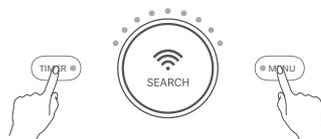
Si el dispositivo no se puede conectar a su teléfono, pulse los botones "Function" (Función) y "Timer" (Temporizador) a la vez durante 5 segundos para reiniciarlo. La luz indicadora amarilla parpadeará para indicarle que el Wi-Fi se ha restablecido correctamente y que puede volver a conectarse a la red.
