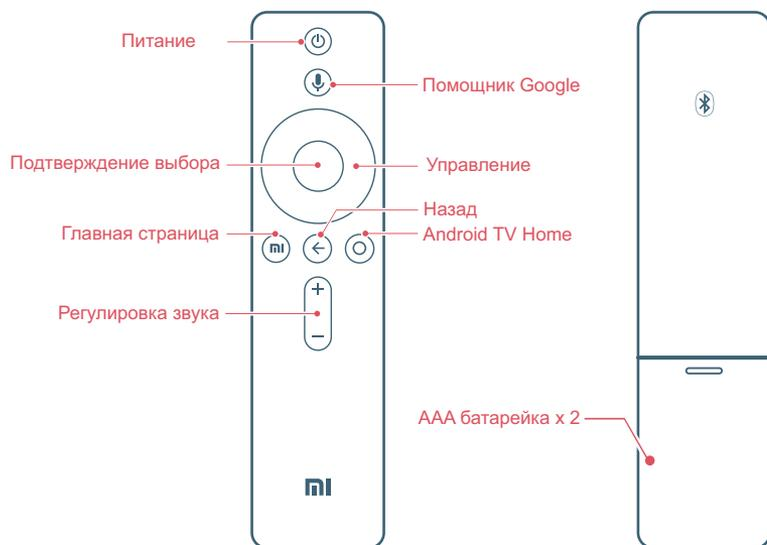
**Питание:** Короткое нажатие для выключения телевизора; длительное нажатие для выключения или перезапуска телевизора.
